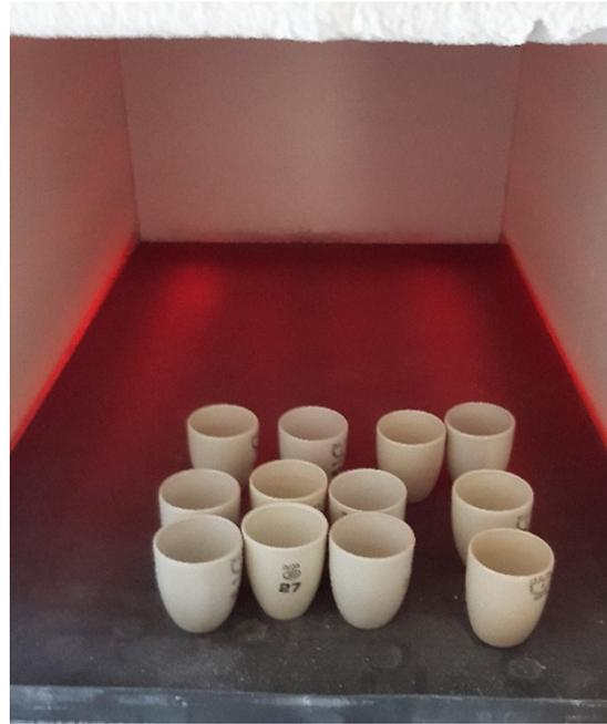
**Abbildung 11** Ausglühen der Tiegel und Veraschung bei 650°C (Bildautor: von Ahn).
