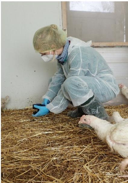
**Abbildung 21** Ammoniakmessung mittels Drägerröhrchen- und pumpe (Bildautor: Lehnert).
