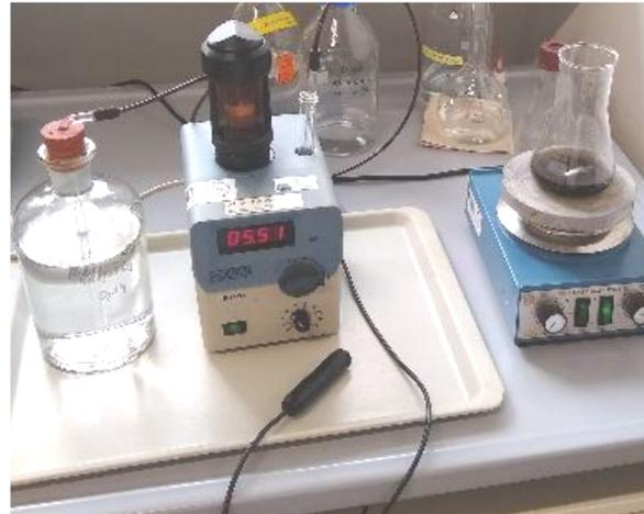
**Abbildung 6** Titration mittels elektronischer Titrierhilfe (links). Auf Magnetrührer stehender Erlenmeyerkolben, gefüllt mit bereits mit Stärkelösung versetzten Jodlösung (rechts; Bildautor: Wedmann).
