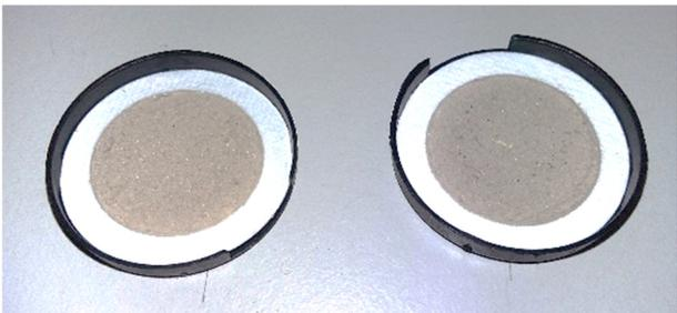
**Abbildung A5** Entnommene staubbeladene Filter nach einer Messdauer von 24 h auf Filterträgern (Bildautor: Umbach).
