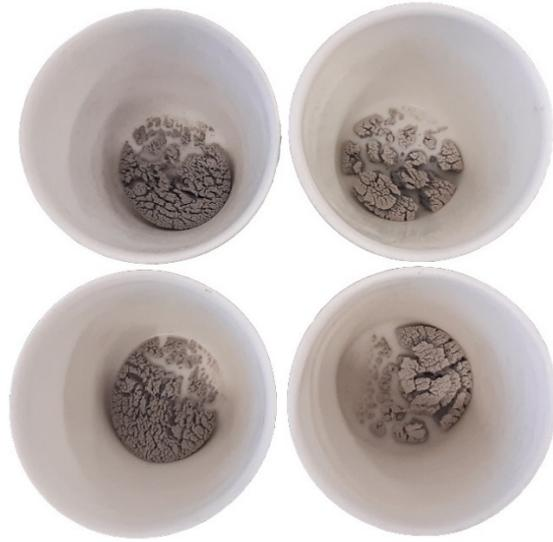
**Abbildung 14** Aschereste in Porzellantiegeln (Bildautor: von Ahn).
