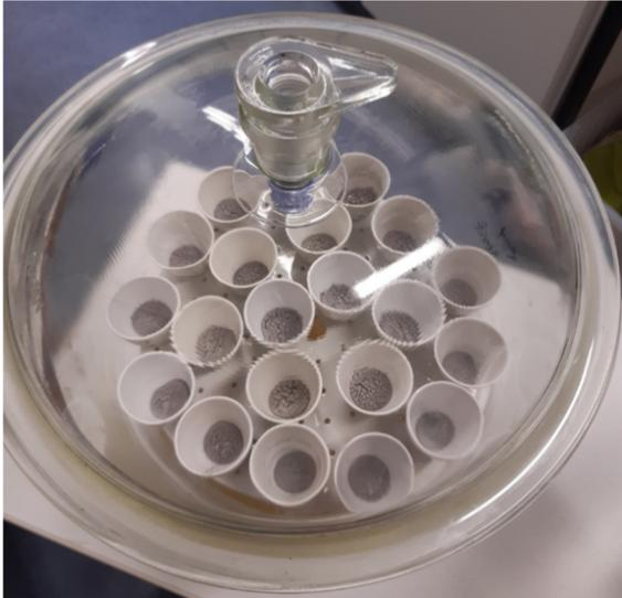
**Abbildung 13** Exsikkator zur trockenen Lagerung und zum Abkühlen lassen von heißen Proben (Bildautor: von Ahn).
