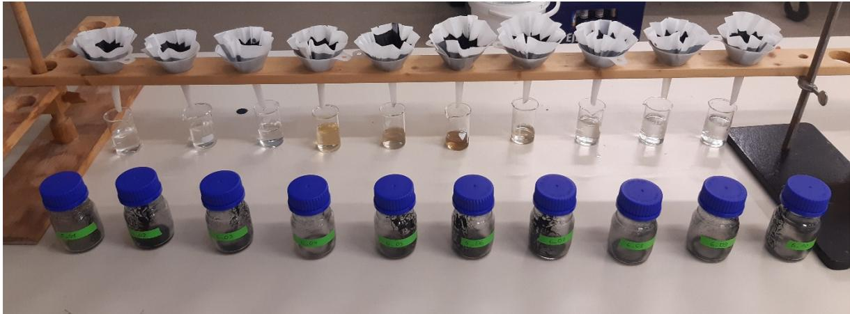
**Abbildung 9** Filterbank für die Analyse der Leitfähigkeit von Kohlensuspensionen (Bildautor: von Ahn).
