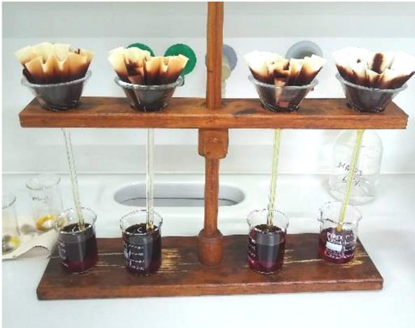
**Abbildung 5** Filtration der Kohle-Jodlösungssuspension deutlich zu erkennen ist die rotbraune Färbung des Filtrats (Bildautor: Wedmann).
