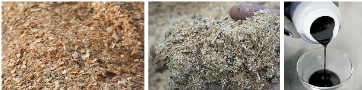
**Abbildung 8** Holzspäne (links) und Holzmehl (Mitte) als relevante sekundäre Reststoffe aus der Holzindustrie sowie Schwarzlauge (rechts) aus der Zellstoff- und Papierindustrie im Regierungsbezirk Kassel.
