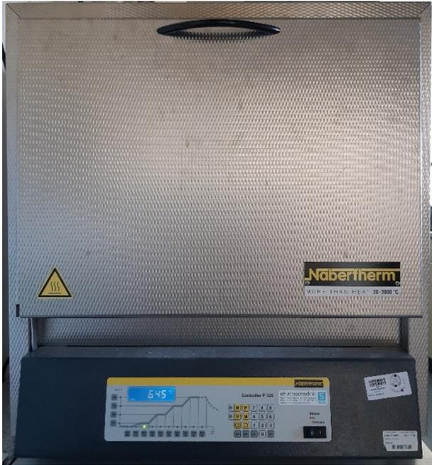
**Abbildung 10** Nabatherm CP320 Programmierbarer Muffelofen (Bildautor: von Ahn).
