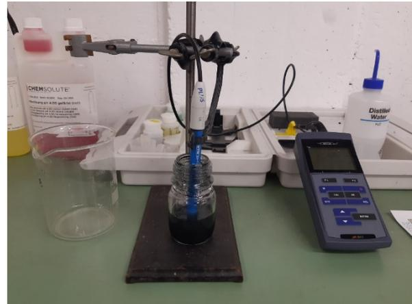
**Abbildung 8** Messaufbau zur pH-Bestimmung der Kohlesuspension (Bildautor: von Ahn).
