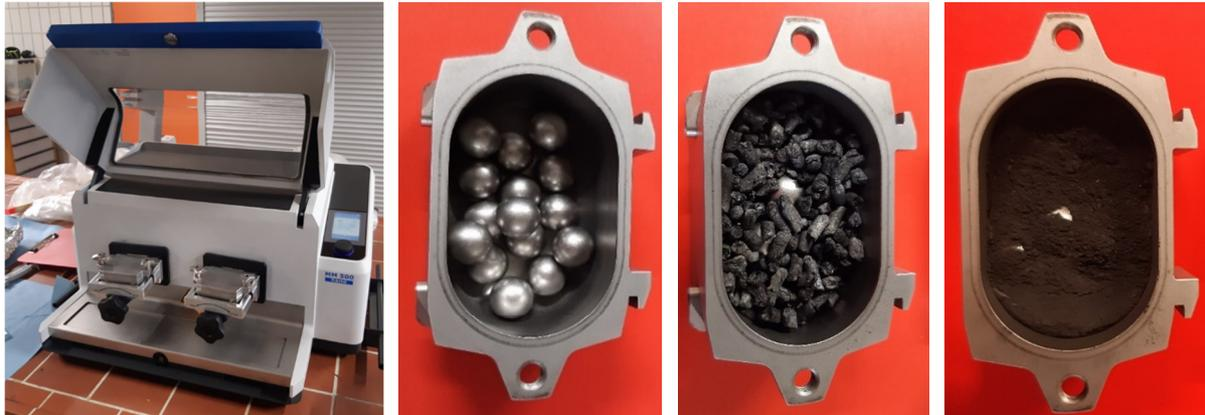
**Abbildung 4** Schwingmühle SM500nano von Retsch mit den verschiedenen Stufen der Verarbeitung: 1. Füllung des Mahlgefäßes mit Stahlkugeln, 2. Hinzugeben der Probe, 3. Prüfung des Ergebnisses (Bildautor: von Ahn).
